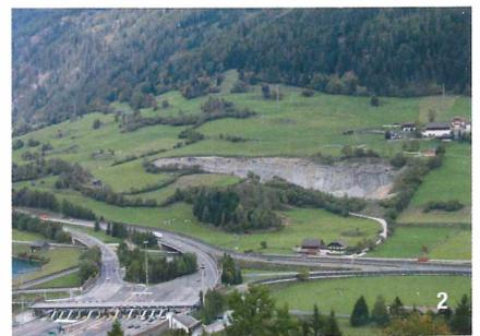
**Abb. 1:** Blick in den Esslbruch von der Steinbruchkante (Situation am 6. 10. 2013). Rechts im Foto deutlich zu erkennen ist das engständige, fast senkrecht stehende Kluffnetz, das den Steinbruch durchzieht. Foto Ch. Steinwender, Wien.
