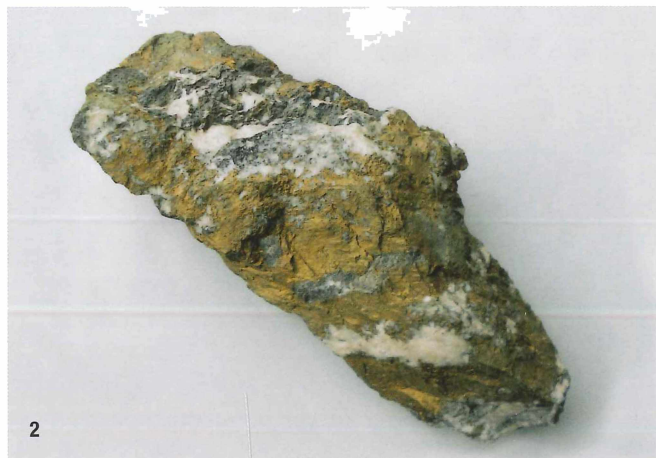
Abb. 2: Wahrzeichen (Rückseite): Kupferkies, Quarz und Graphitschiefer; Kupferplatte bei Jochberg/Tirol, Hl. Geist Erbstollen, 4. Klüft. Stufe 33 x 13 x 8 cm. Sammlung: Montanbehörde Wien; Foto: A. Weiß, Wien.
