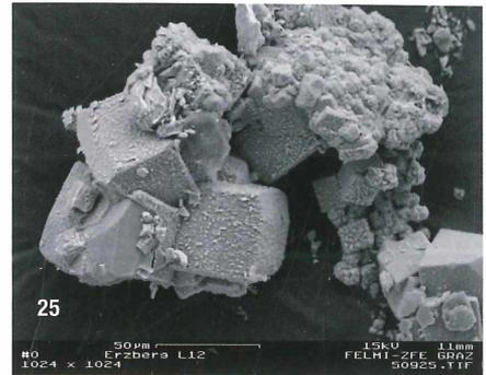
**Abb. 25:** Zwei Generationen von Pyrit auf Dolomit, die teilweise mit einer „Tonmineralkruste“ bedeckt sind. Steirischer Erzberg. Sammlung: A. Leskovar, Bruck/Mur (L12). Foto: REM-Aufnahme, SE-Modus, Zentrum für Elektronenmikroskopie Graz.
