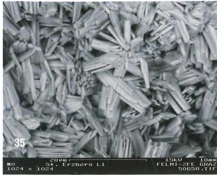
**Abb. 35:** Typisch etwas konisch zulaufende Pyrolusitkristalle in sternförmigen Aggregaten als Kruste. Steirischer Erzberg. Sammlung: A. Leskovar, Bruck/Mur (L1). Foto: REM-Aufnahme, BSE-Modus, Zentrum für Elektronenmikroskopie Graz.
