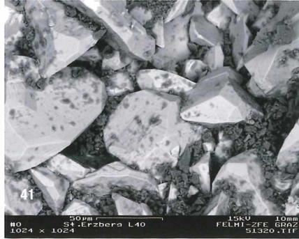
**Abb. 41:** Formenreiche und stark verzerrte Sphaleritkristalle. Steirischer Erzberg. Sammlung: A. Leskovar, Bruck/Mur (L40). Foto: REM-Aufnahme, BSE-Modus, Zentrum für Elektronenmikroskopie Graz.
