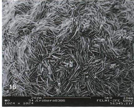
**Abb. 16:** Oberfläche eines Hämatitaggregates. Steirischer Erzberg. Sammlung: G. Fallent, Weinitzen (8386). Foto: REM-Aufnahme, SE-Modus, Zentrum für Elektronenmikroskopie Graz.
