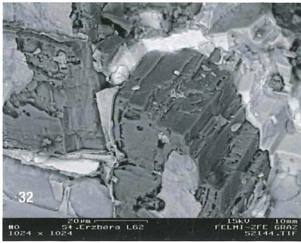
**Abb. 32:** Pyrit- oder Markasitlagen zwischen Fe-Dolomiten. Steirischer Erzberg. Sammlung: A. Leskovar, Bruck/Mur (L62). Foto: REM-Aufnahme, BSE-Modus, Zentrum für Elektronenmikroskopie Graz.
