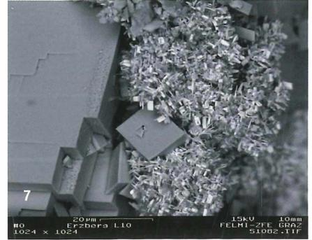
**Abb. 7:** Zellig aufgebaute „Bravoit“-Kristallaggregate mit würfeligem Pyrit auf Ankerit. Steirischer Erzberg. Sammlung: A. Leskovar, Bruck/Mur (L10). Foto: REM-Aufnahme, BSE-Modus, Zentrum für Elektronenmikroskopie Graz.
