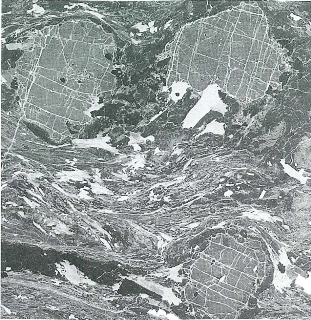
Abb. 3 Dünnschliff-Foto eines Granat-Cordierit-Sillimanit-Gneis (Kinzigit) vom Hennenkobel bei Zwiesel (Foto: Madel).
