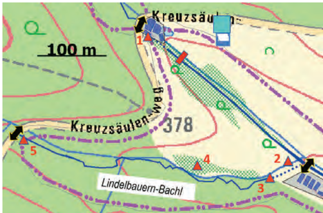
Abb. 10: Abschnitt 2c des Grundoblbachs und unterer Teil des Lindelbauern-Bachls. Dunkelblaue Linien = Bachlauf nach GPS, gepunktete Linien = verödeter Bachlauf, hellblaues Quadrat = Brunnenhaus, rote Dreiecke = spezifische Beeinträchtigungen, grüne Kreuzschraffur = biotopkartierte Bereiche. Das obere rote Dreieck steht für den fehlenden unmittelbaren Zulauf in den Grundoblbach, das untere für eine Staudenknöterich-Brache.
