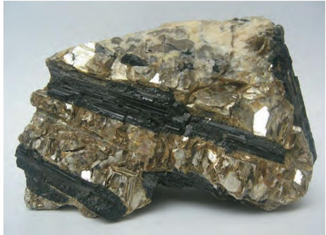
Abb. 12: Pegmatitisches Gestein mit Schörl (schwarzer Turmalin), Quarz, Alkalifeldspat und Muskovit (Wikipedia).
