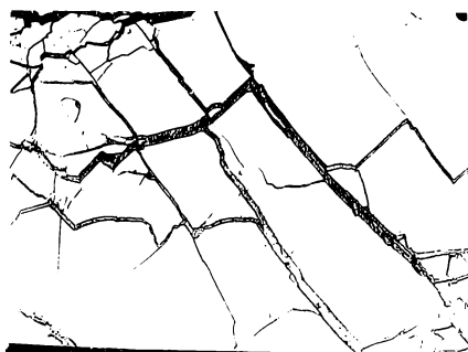
Abb.2 Vergr. 75 x Chromerzanschliff auf Holz poliert.
