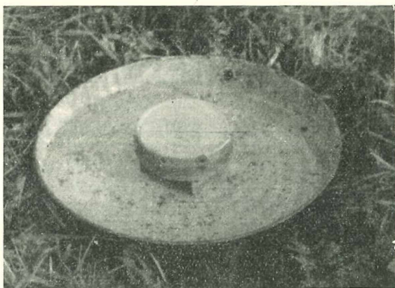
Abb. 3. Gelbschale aus Bakelit mit Überlauföffnung (hinterer Rand) und Schuttschachtel für die Lockschale.
