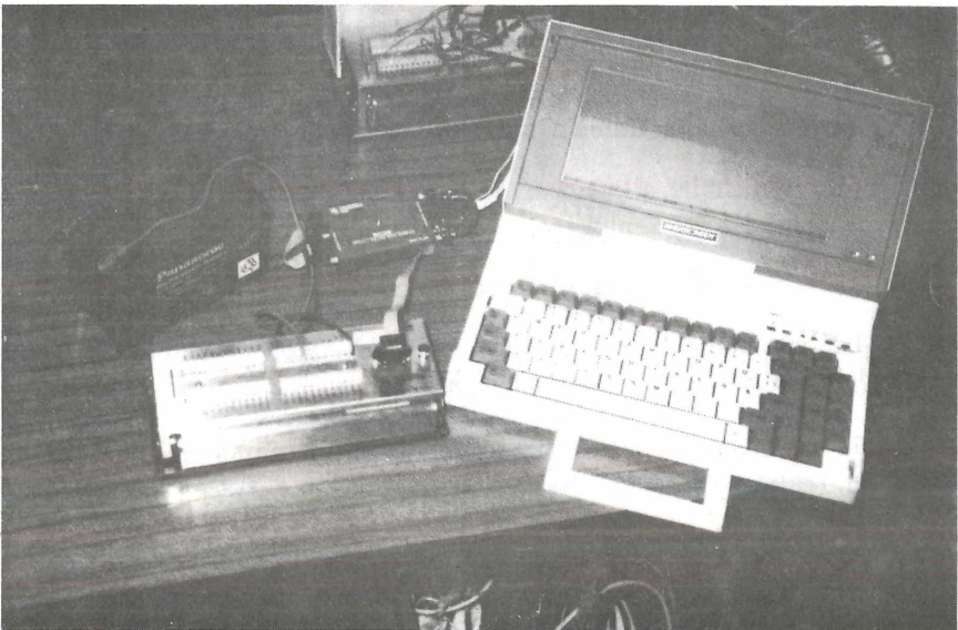
Abbildung 2.6: Der Datenlogger von Campbell Scientific, die Anschlußleiste für die Sensoren an seiner Oberseite sind deutlich zu erkennen, links oben die Batterie, rechts daneben das Interface zum Computer, und der tragbare batteriebetriebene Laptop mit aufgeklapptem Bildschirm.
