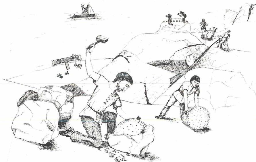
Abb. 8: Rekonstruktionszeichnung der Kugelherstellung am Drachenfels bei Königswinter. Im Hintergrund werden die Trachytblöcke im Steinbruch gewonnen, auf Rutschen zum Rhein niedergebracht und auf Lastschiffe oder Flöße verladen. Im Vordergrund ein Werkplatz; Steinmetze meieln die Kugeln mit Spitzeisen und Fustel aus den Trachytblcken heraus (Grafik D. WEHNERT).
