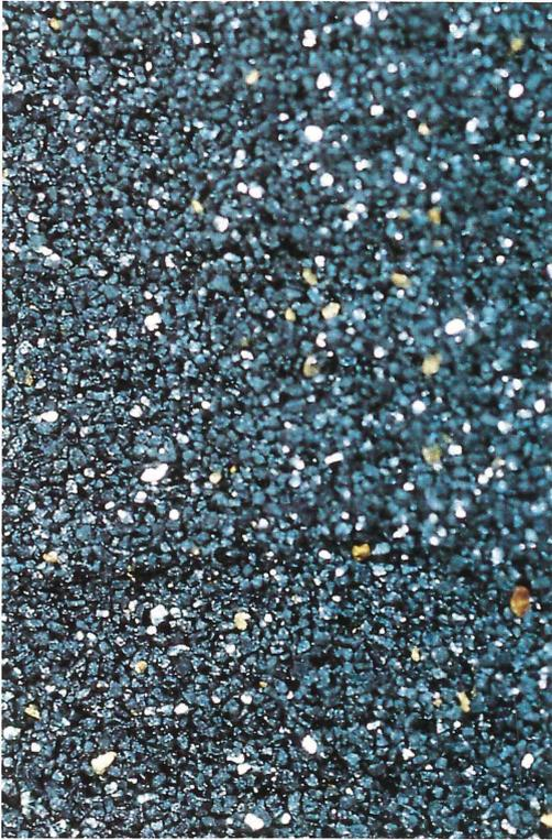
Abb. 22: Schwermineralkonzentrat mit freiem Berggold aus der Aufbereitungsanlage des Erzbergwerkes Grund; Vergrößerung 14 x.
