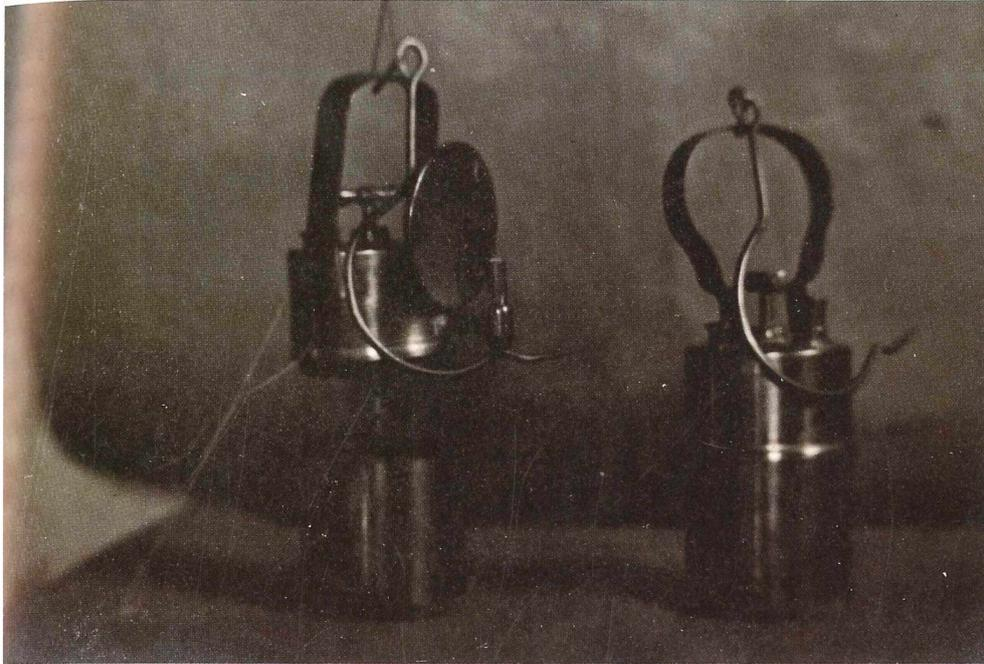
**Abb. 30:** Acetylen-Handlampen mit Hoch- und Seitenbrenner aus dem Wassertank, vermutlich Schraubverschluß, ca. 1912/13, möglicherweise Nachbau der Fa. Stöcker nach Mustern von Kämpfe & Thonig oder anderen ostdeutschen Firmen.
