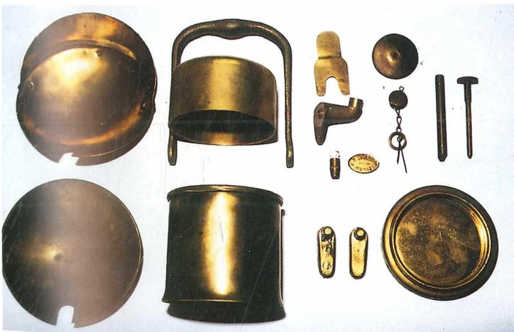
**Abb. 4:** Einzelteile einer Messing-Handlampe.
