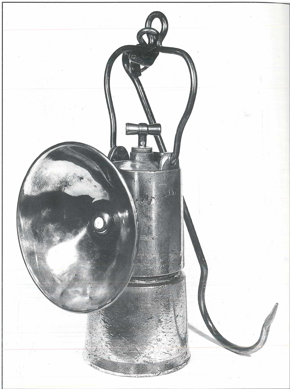
Abb. 68: Granatlampe Material: Messing Höhe: 18,3 cm Baujahr: um 1926 Bemerkung: Typ 65, Schraubverschluß
