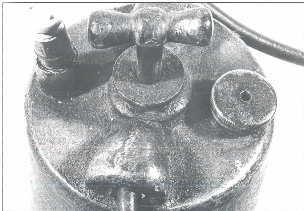
Abb. 15: Anordnung der Armaturen auf den Granatlampen: Messing-Granatlampe (o.), Eisen-Zink-Granatlampe (u.).
