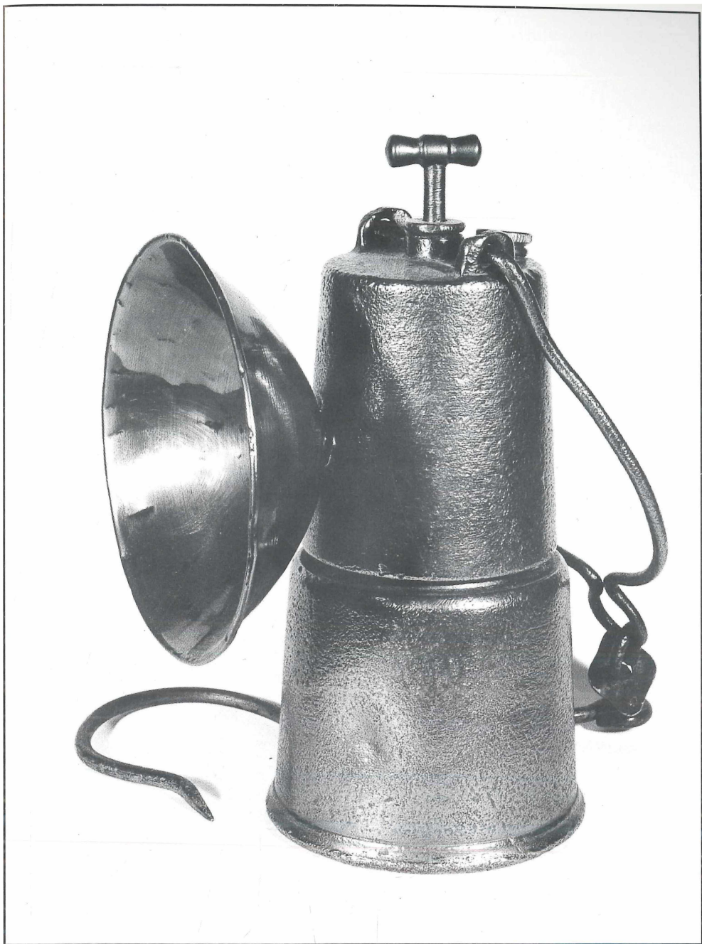
Abb. 67: Granatlampe Material: Messing Höhe: 19,0 cm Baujahr: um 1915 Bemerkung: Typ 65, Schraubverschluß
