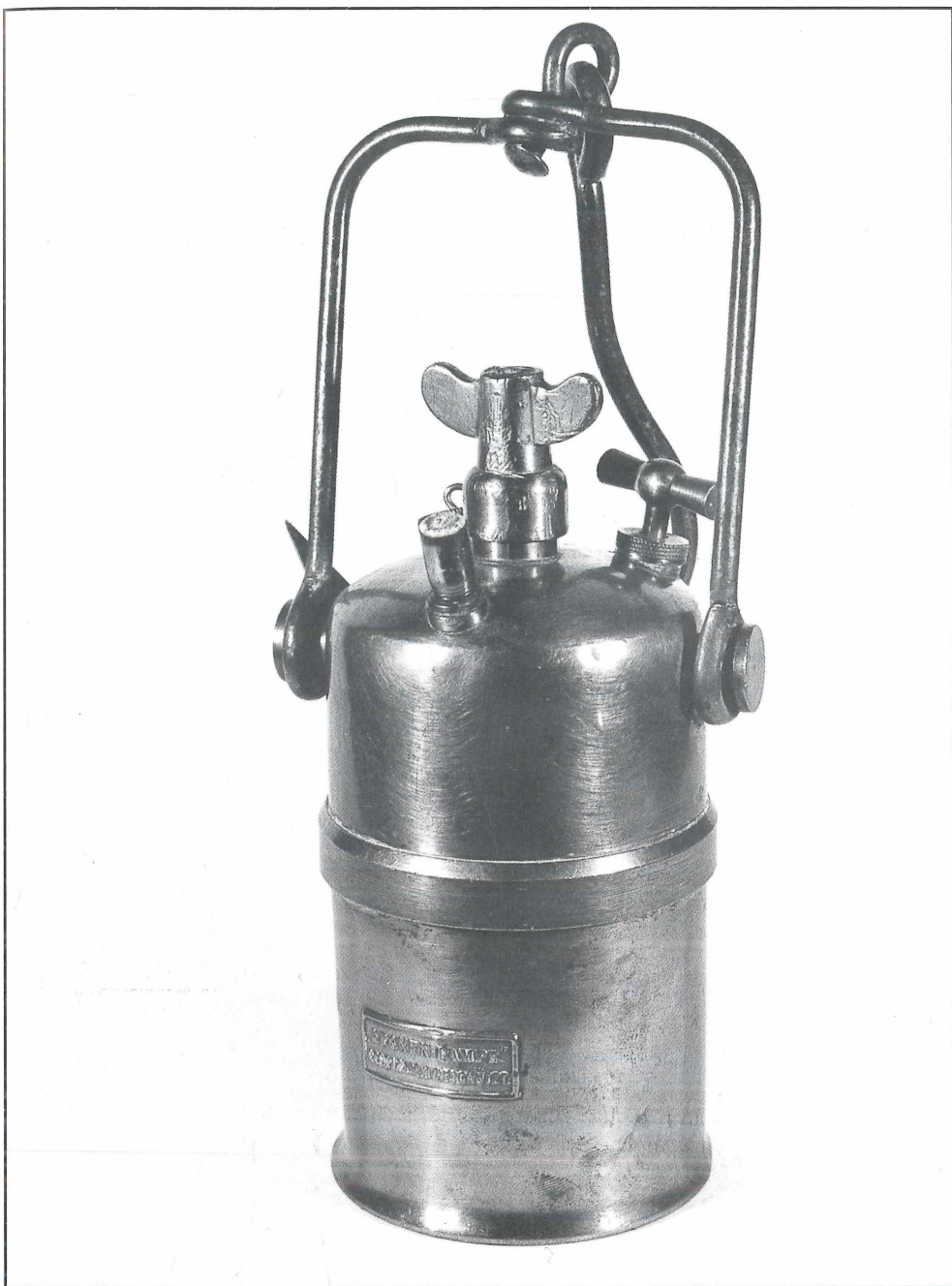
Abb. 57: Kronenlampe Material: Messing Höhe: 12,3 cm Baujahr: um 1910 Bemerkung: Typ 2, Flügelmutterschluß
