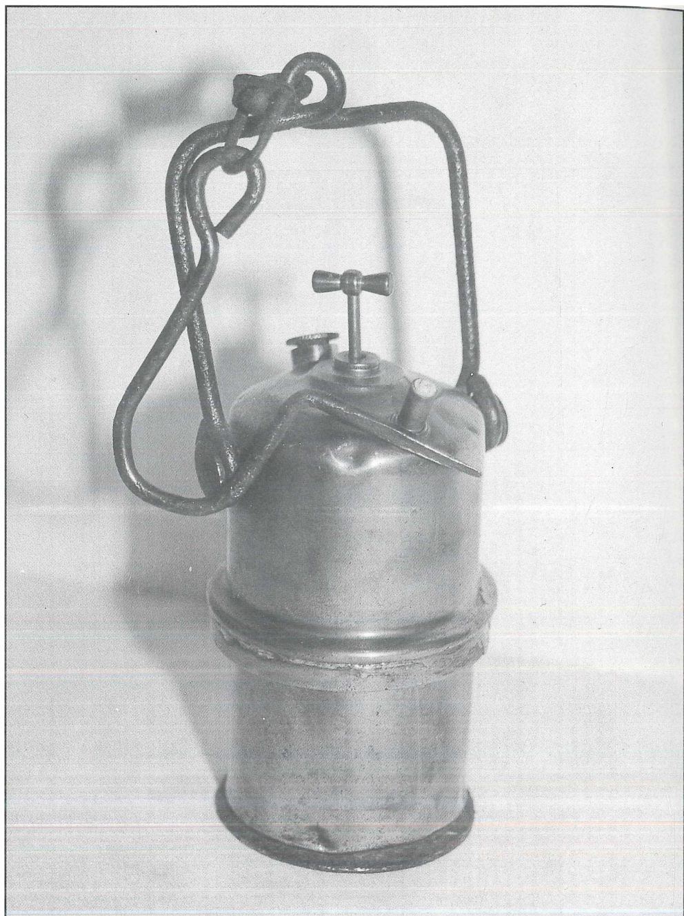
Abb. 54a: Acetylen-Handlampe Material: Messing Höhe: 17 cm Baujahr: vor 1907 Bemerkung: Schraubboden-Verschluß, Schraubboden ergänzt (Eisen)
