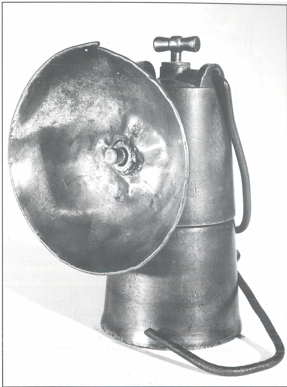
Abb. 73: Granatlampe Material: Aluminium Höhe: 16,1 cm Baujahr: um 1937 Bemerkung: Typ 70, Schraubverschluß
