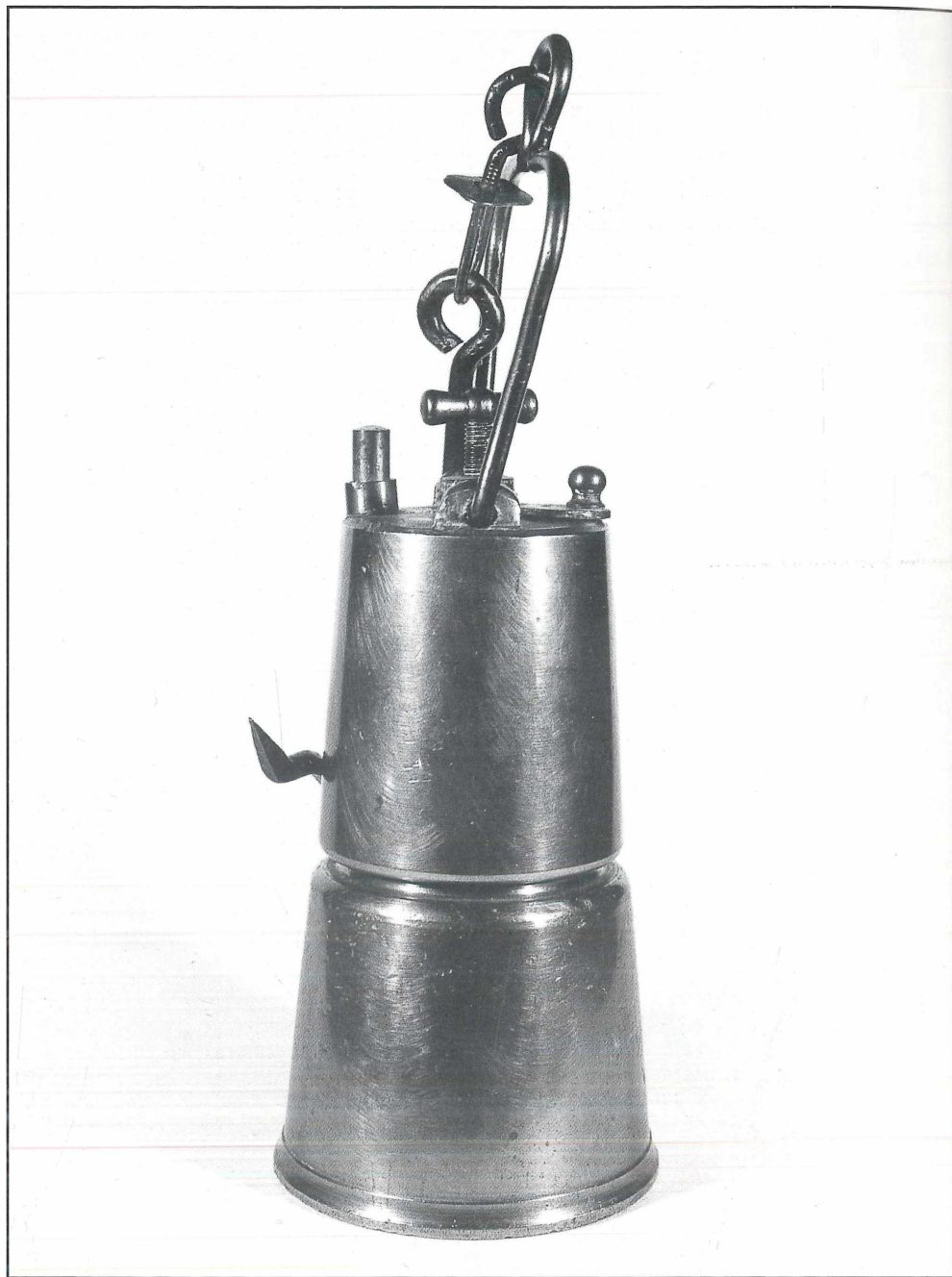
Abb. 70: Granatlampe Material: Messing Höhe: 17,8 cm Baujahr: um 1908 Bemerkung: Typ 59, Schraubverschluß, Drehschieberverschluß auf Wassertank
