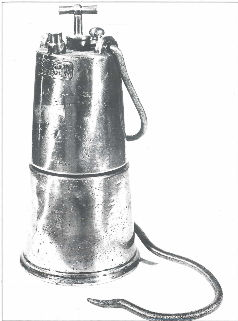
Abb. 63: Granat-Lampe Material: Messing Höhe: 18,9 cm Baujahr: um 1908 Bemerkung: Typ 59, Schraubverschluß, Herstellerschild mit Aufschrift: Granatlampe Rötelmann
