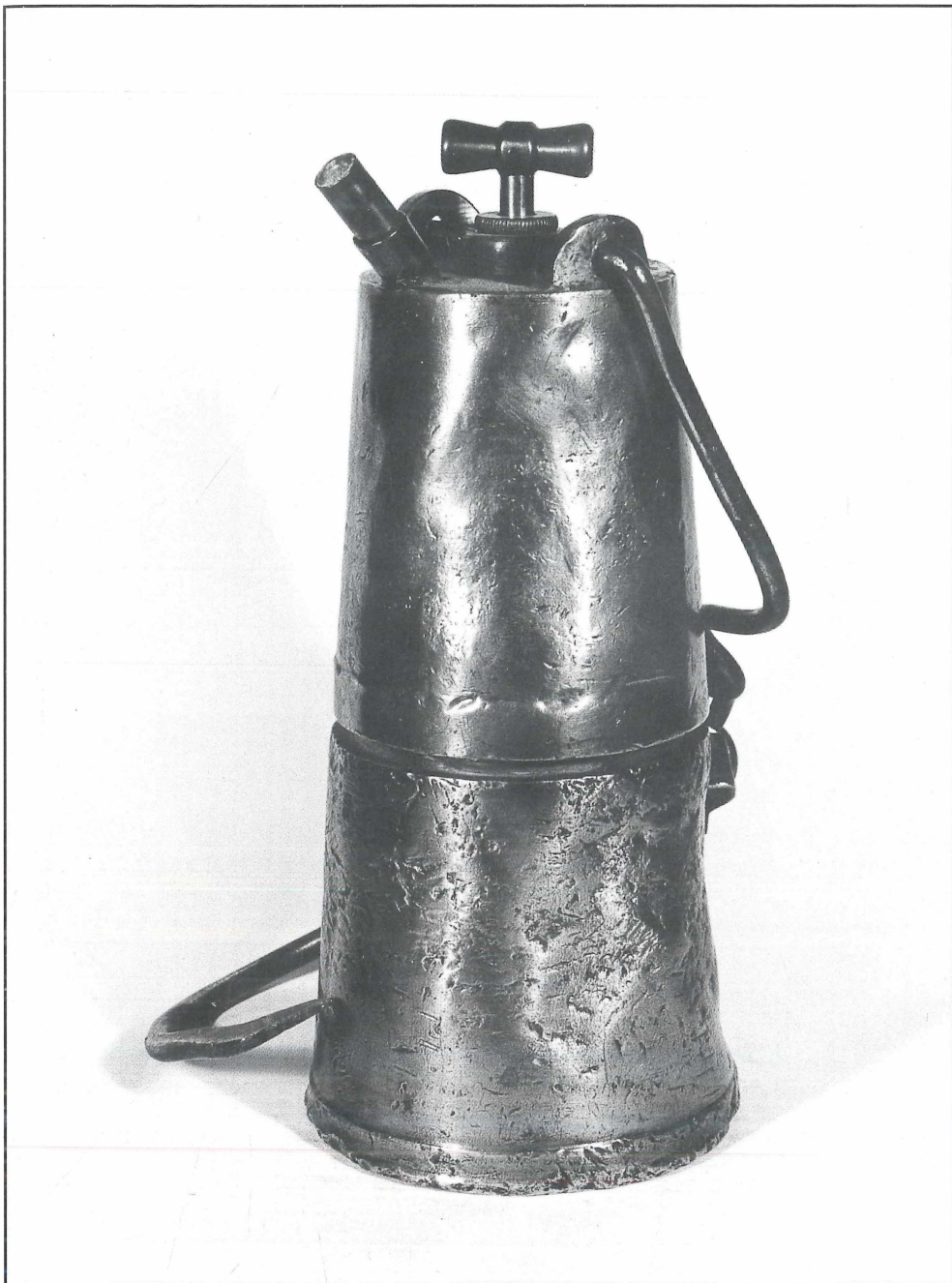
Abb. 65: Granatlampe Material: Messing Höhe: 18,8 cm Baujahr: um 1915 Bemerkung: Typ 59, Schraubverschluß
