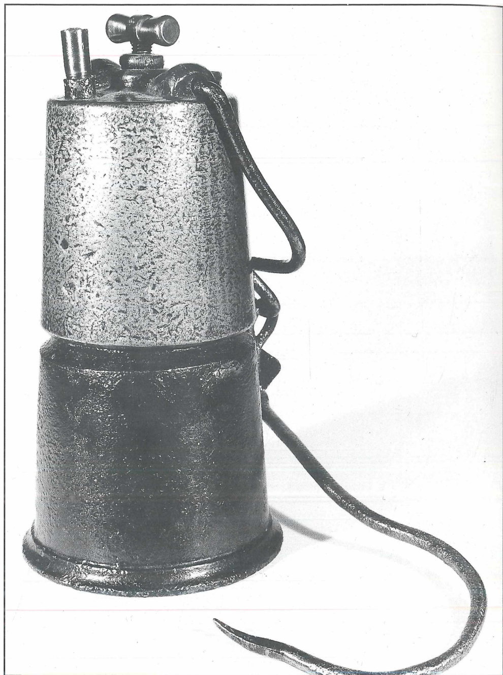
Abb. 74: Granatlampe Material: Eisen/Zink Höhe: 18,5 cm Baujahr: um 1920 Bemerkung: Schraubverschluss, Stopfbuchse aus Zink
