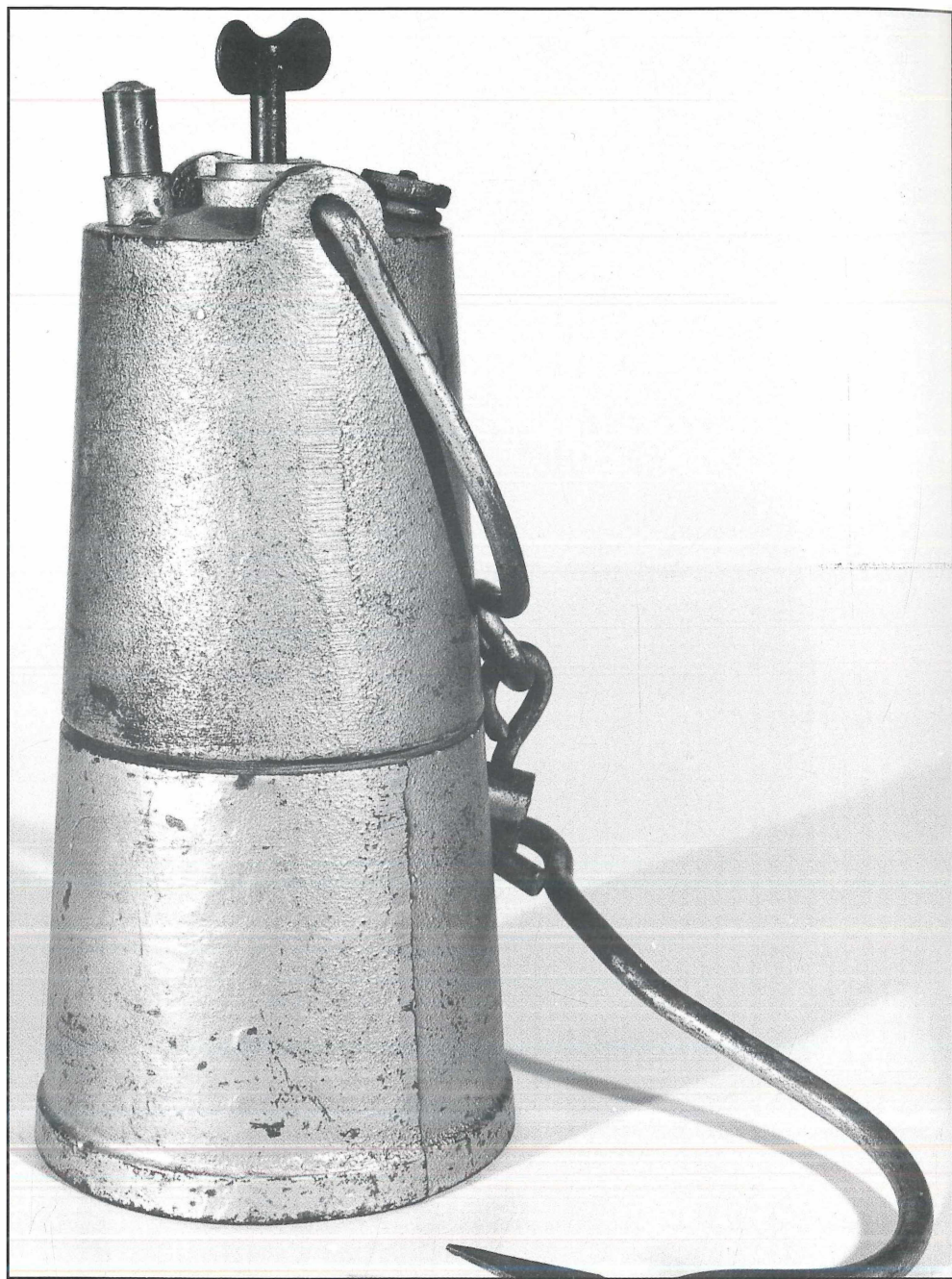
Abb. 78: Granatlampe Material: Eisen Höhe: 19,1 cm Baujahr: um 1940 Bemerkung: Typ 80, Schraubverschluß, Originallack, Ventilgriff aus Blech gestanzt
