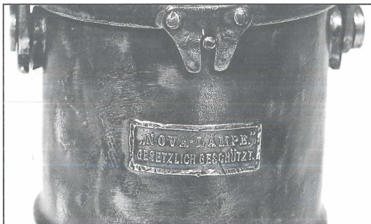
Abb. 13: Firmenschilder der Fa. Gebr. Rötelmann auf Kronen- und Nova-Lampen, wobei die Typenschilder jeweils mit dem Firmenschild kombiniert wurden (etwa 1908).
