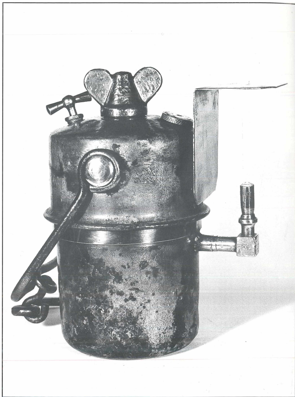
Abb. 58: Kronenlampe Material: Eisen, verzinkt Höhe: 17,9 cm Baujahr: ab 1908 Bemerkung: Typ 17a, Flügelmutterverschluß, aufsteckbares Schutzdach
