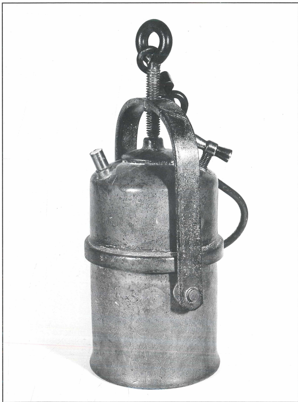
Abb. 87: Bügellampe Material: Eisen Höhe: 15,8 cm Baujahr: um 1937 Bemerkung: Typ 192 S, Spannschrauben-Bügelverschluß
