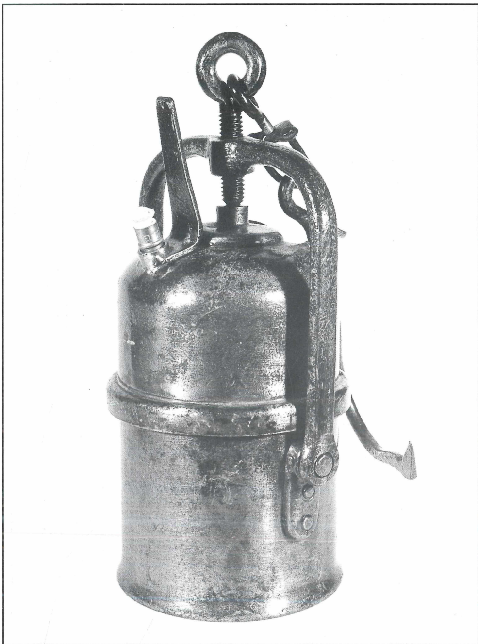
Abb. 85: Bügellampe Material: Eisen Höhe: 15,0 cm Baujahr: um 1930 Bemerkung: Typ 93, Spannschrauben-Bügelverschluß, Hängeohren abgeändert (siehe Abb 83)
