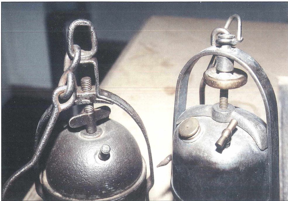
Abb. 22: Lampen von Brumberg und Dax (Schnecke) im Vergleich. Man beachte die unterschiedliche Gewindeführung des Spannrades.
