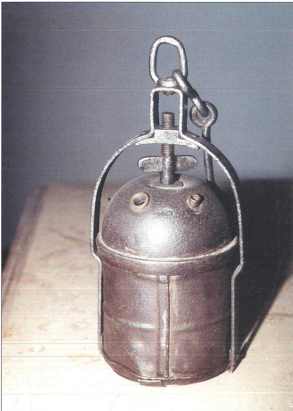
Abb. 20: Acetylen-Handlampe Material: Eisen Baujahr: nach 1905 Bemerkungen: sogen. Dax-Lampe, Spannrad-Bügelverschluss mit Gewindeführung im Bügel
