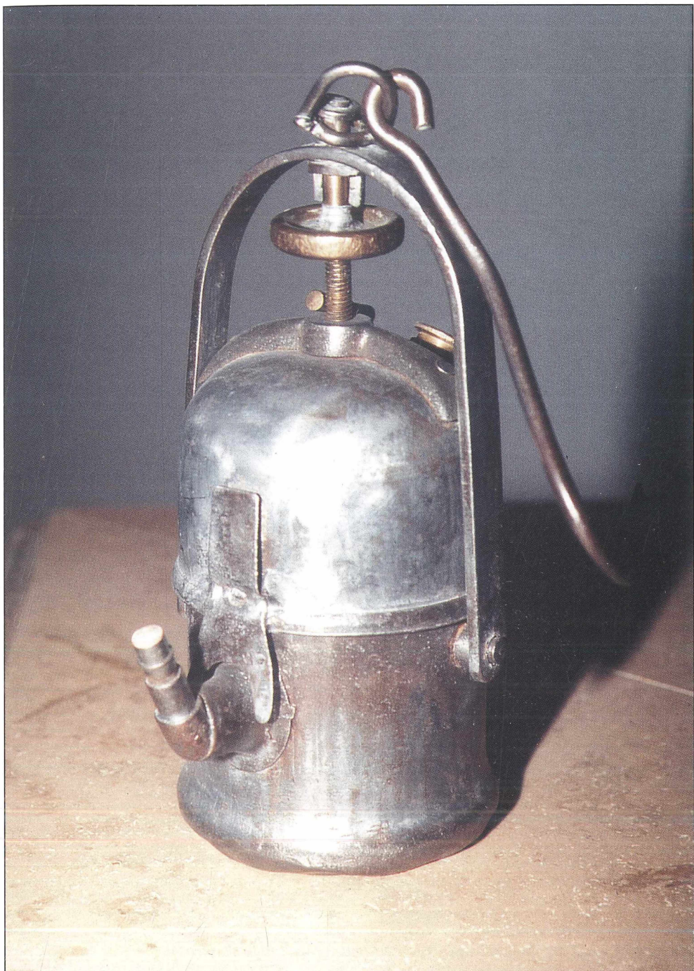
Abb. 21: Acetylen-Handlampe Material: Eisen Höhe: 16,5 cm Baujahr: nach 1922 Bemerkungen: Lampe von Brumberg, Modell II, Spannrاد-Bügelverschluss mit Gewindeführung im Wassertank
