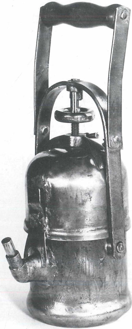
Abb. 27: Acetylen-Handlampe Material: Eisen Höhe: 16,5 cm Baujahr: ab 1921 Bemerkungen: Modell II (Nr. 1952), 2. Version mit balkenartiger Verstärkung auf dem Wassertank, Spannrads-Bügelverschluss
