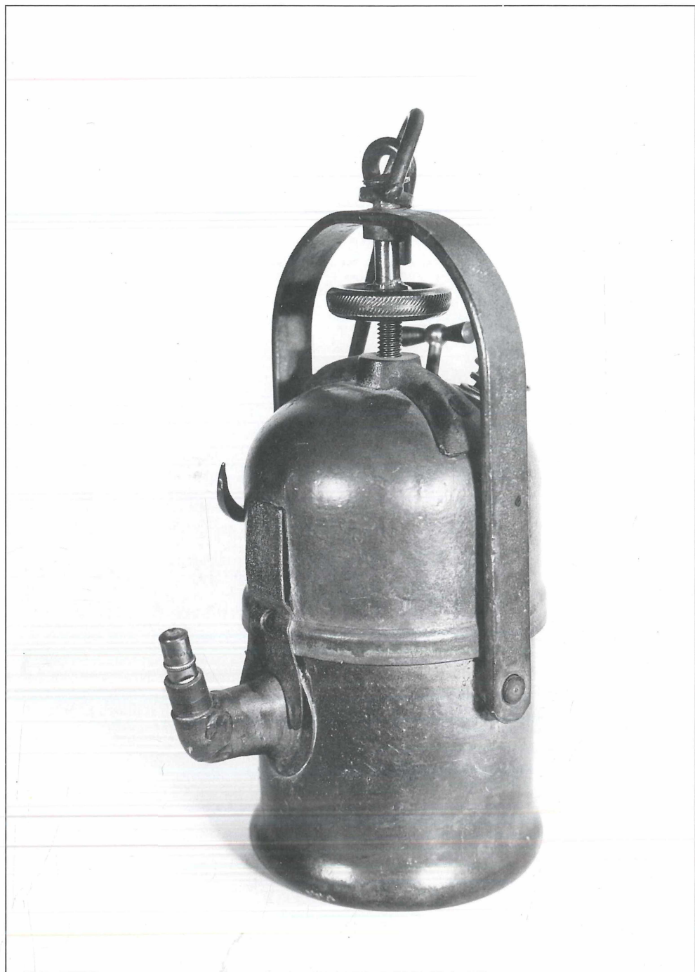
Abb. 26: Acetylen-Handlampe Material: Eisen Höhe: 16,5 cm Baujahr: nach 1922 Bemerkungen: Modell II (Nr. 1950), 2. Version mit balkenartiger Verstärkung auf dem Wassertank, Spannrade-Bügelverschluss
