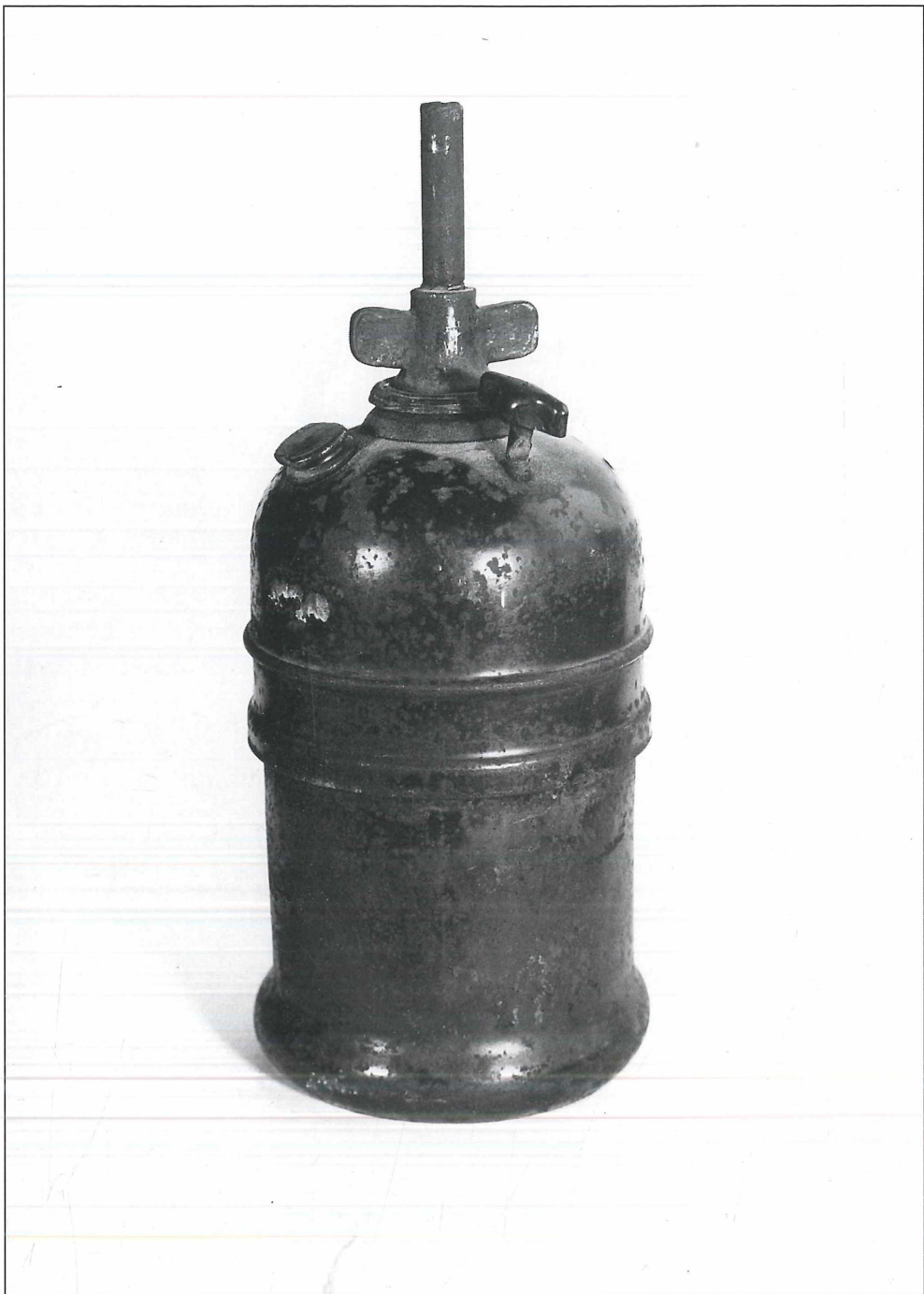
Abb. 37: Acetylen-Hauslampe Material: Eisen Höhe: 23,5 cm Baujahr: ab 1939 Bemerkungen: RAD-Lampe mit doppeltem Wulst für Reflektorhalterung und ausgebauchtem Karbidtopf, Flügelmutter-Verschluss
