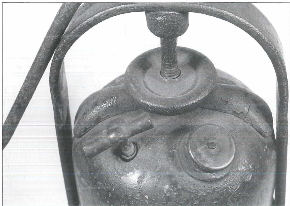
Abb. 16: Detailansicht des Oberteils von Modell II mit Spannrad-Bügelverschluss: 1. Version mit Gewindehülse im Wassertank, (oben) 2. Version mit Balkenverstärkung auf dem Wassertank (unten), Anordnung von Wassertankdeckel und Ventilspindel beliebig
