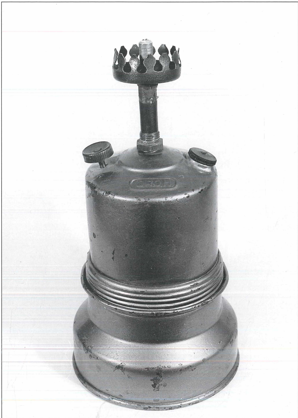
Abb. 33: Acetylen-Hauslampe Material: Eisen Höhe: 21,5 cm Baujahr: ab 1918 Bemerkungen: Grundform der Modelle Nrn.12, 15 und 16 ohne Reflektor oder Schirm (siehe Abb.: 28), Schraub-Ring-Verschluss
