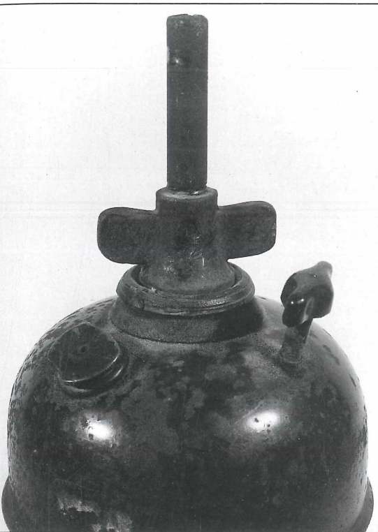
Abb. 32: Detailansichten der RAD-Lampen mit Flügelmutter und Original-Ventilspindel. Die untere Flügelmutterform wurde auch von Friemann & Wolf benutzt.
