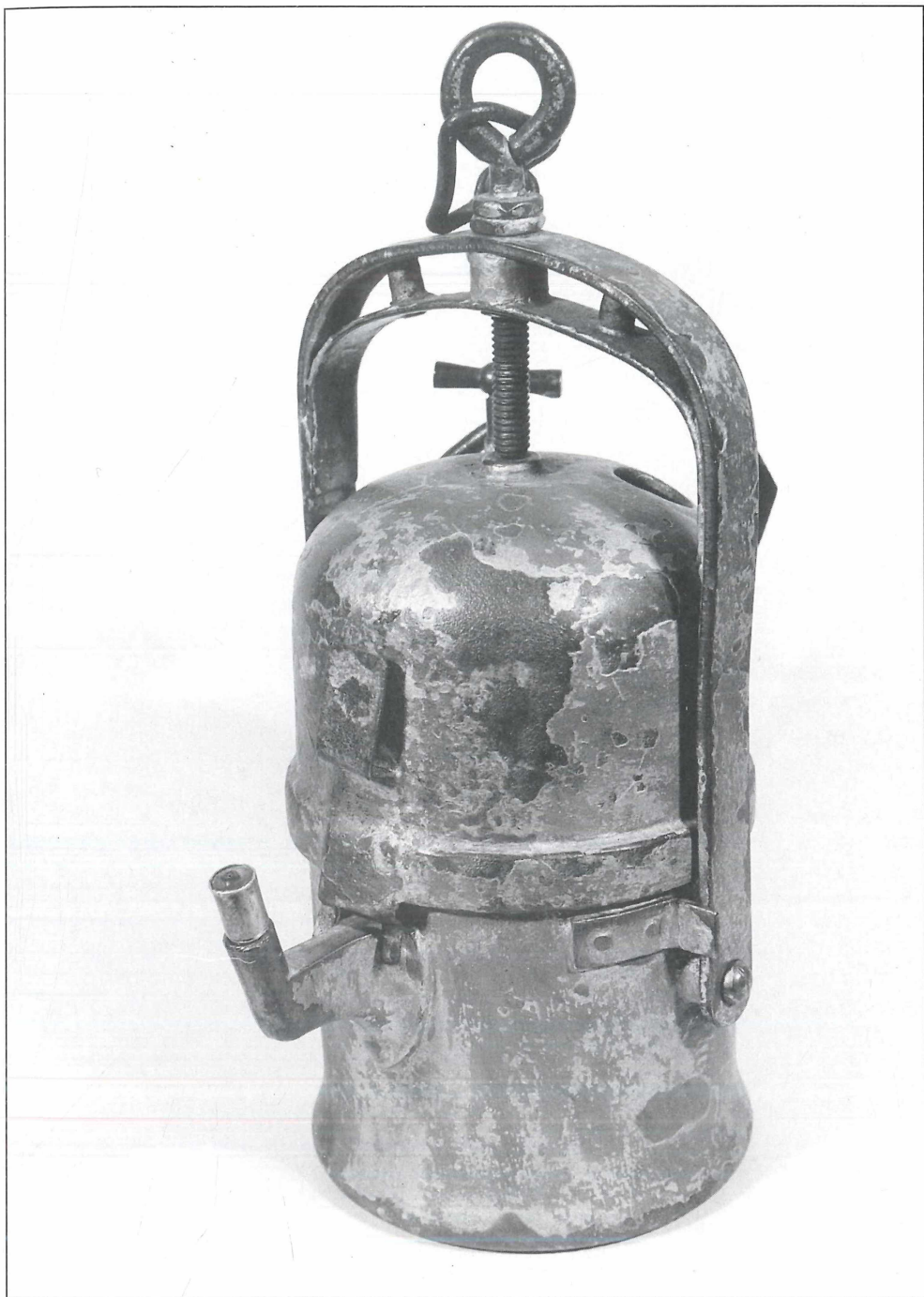
Abb. 19: Acetylen-Handlampe Material: Eisen Höhe: 15,5 cm Baujahr: vor 1914 (nach 1902 ?) Bemerkungen: Modell I, Spannschrauben-Bügelverschluss, Reste der Originallackierung, Bügelanschlag mit Karbidtopf vernietet
