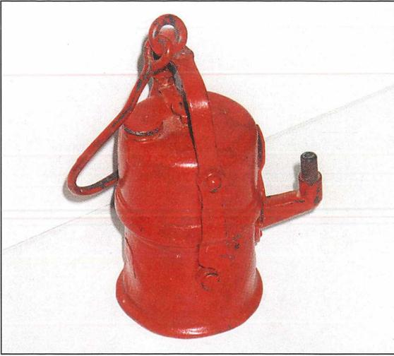
**Abb. 7:** Karbidlampe von Friemann & Wolf GmbH, aus Zwickau. Typ 850, Größe 3, mit Gelenkbügelverschluss aus Eisen. Gefahren von Schießhauer Ewald SCHRÖDER im Braunkohlentiefbau der Zeche Hirschberg um 1930 (Lampe: Höhe 153 mm, Durchmesser 72 mm).
