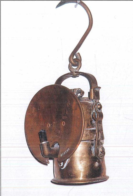
**Abb. 8:** Beamten-Karbidlampe von Hesse / Nürnberg, Typ 132/3 mit Gelenkbügelverschluss aus Messing. Gefahren von Berginspektor Wilhelm BUSCHE im Braunkohlentiefbau der Zeche Hirschberg um 1940. Die Lampe ist 155 mm hoch und hat einen Durchmesser von 70 mm.
