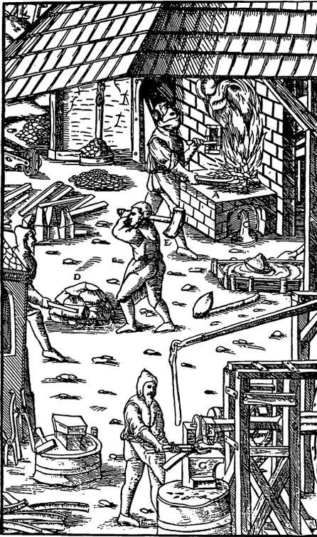
**Abb. 5:** Rennherd mit von Wasserkraft bewegtem Blasebalg zur direkten Gewinnung schmiedbaren Eisens aus Erz. In Bildmitte Befreiung der Luppe von Schlacke durch Bearbeitung mit Holzhämmern. Im Vordergrund Schmiedehammer. Holzschnitt aus G. AGRICOLA's Bergwerksbuch (1556).
