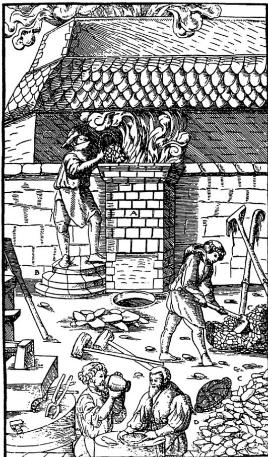
**Abb. 4:** Stückofen um die Mitte des 16. Jahrhunderts. Die im Betrieb behelfsmäßig vermauerte untere Ofenstirnwand wurde später zum Herausziehen des „Stückes“ mit schwerem Gezähe (rechts und links am Bildrand) aufgebrochen. Hinter dem rechten Beschickungsmann zwei Holzhämmer zum Abklopfen der Schlacke vom „Stück“. Ganz links schwerer Aufwerf(schmiede)hammer. Holzchnitt aus G. AGRICOLA's Bergwerksbuch (1556).
