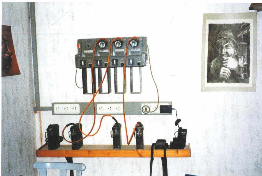
Abb. 14: Einzelplatzladegerät vom Typ Z 350.1 von der CEAG. Zusammengereicht zu einer Kleinladebühne von 4 Kopflampen im Tongrubenbetrieb der Firma Fastner & Co. GmbH (vormals AG Vereinigte Großalmeroder Thonwerke).
