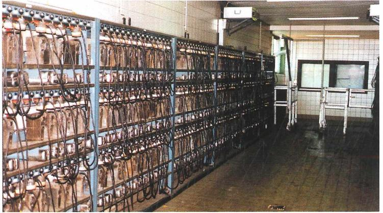
**Abb. 32:** Lampenstube auf dem DSK Bergwerk Prosper Haniel 5, Schacht 10, im Mai 2000. Hier handelt es sich um eine der letzten Lampenstuben des Ruhrkohlenbergbaues, wo noch FRIWO-Kopflampen vom Typ 14202 gefahren werden. Im Hintergrund erkennt man noch recht gut die modernen Ladegeräte, die hier im Jahre 1993 in Betrieb gegangen sind und bisher störungsfrei funktionierten.
