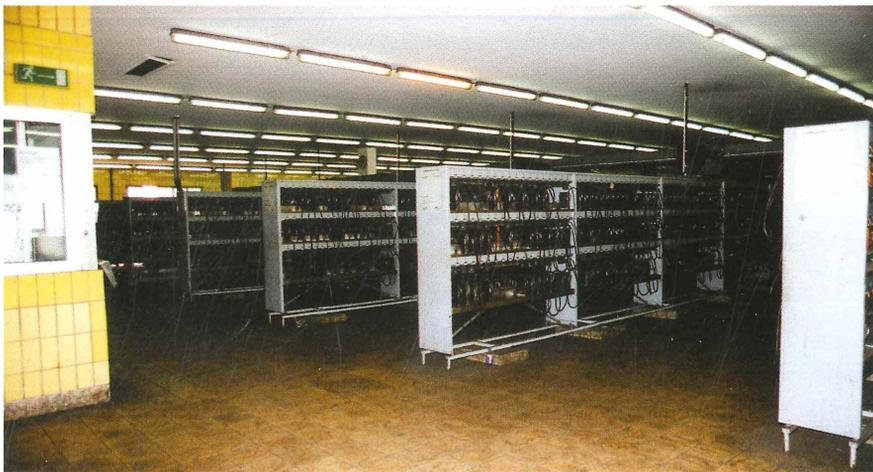
**Abb. 30:** Lampenstube auf dem Verbundbergwerk Lohberg / Osterfeld in Dinslaken der Deutschen Steinkohle AG (DSK) im Mai 2000. Bewirtschaftet werden hier ca. 4.085 CEAG-Kopflampen vom Typ ‚MLC 9.2‘, somit hat Lohberg / Osterfeld die größte Lampenstube der DSK.
