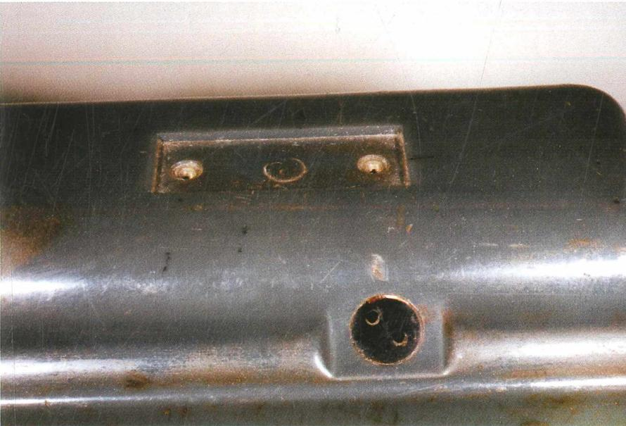
**Abb. 9:** Entgasungsventil an der Seite der Kappe an CEAG-Kopflampe vom Typ ‚MLC 4.1‘.
