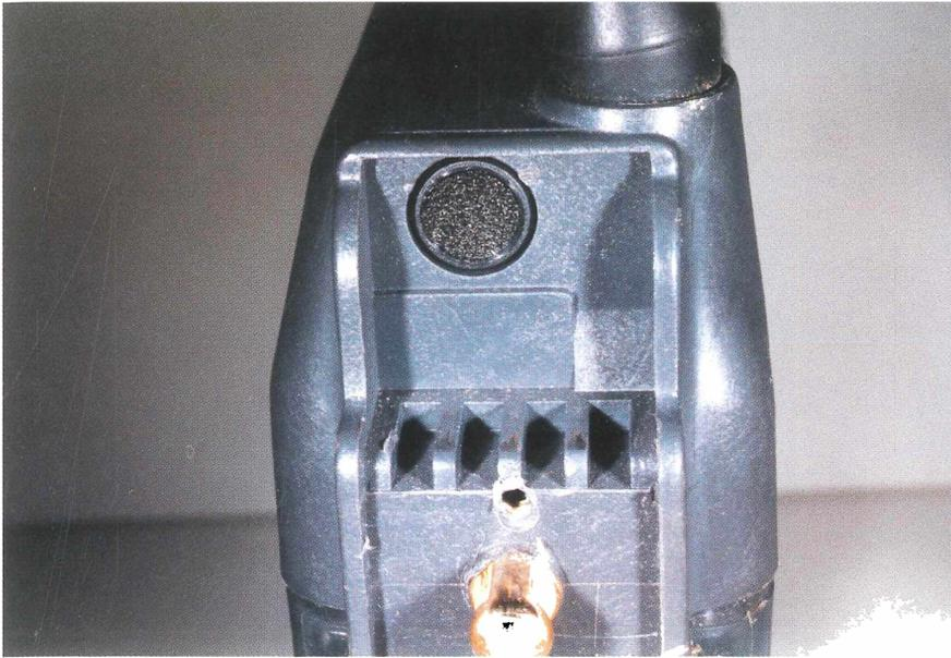
**Abb. 12:** Schaumstoff-Filter am Entgasungskanal der CEAG-Kopflampe vom Typ ‚MLC 9.2‘.
