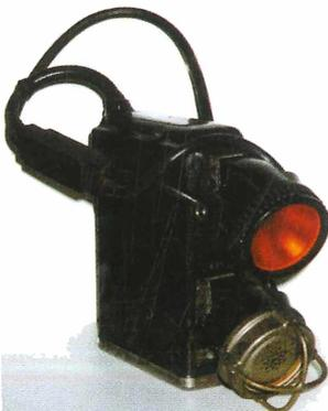
**Abb. 27:** Licht-Ton-Signalgerät CEAG
