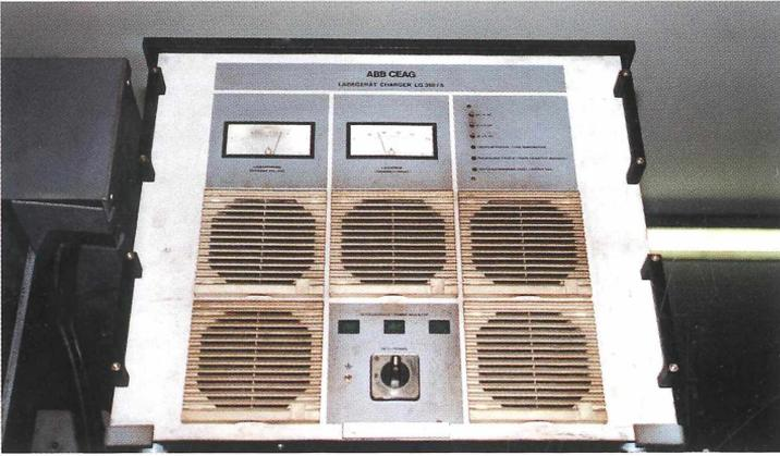
**Abb. 31:** ABB CEAG Ladegerät vom Typ LG 360/5 in der Lampenstube von Lohberg / Osterfeld. Die moderne Ladetechnik lässt die alten und großen Ladegerichter allmählich aus den Lampenstuben verschwinden (vgl. auch die Abb. 32).
