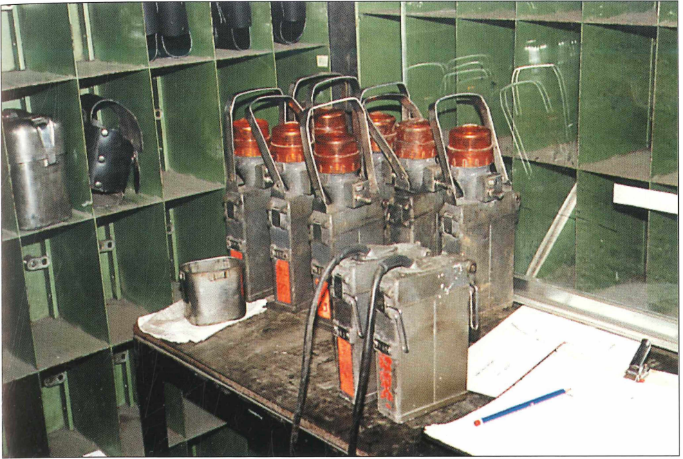
Abb. 10: FRIWO-Zugschlussblinkleuchten in der Werkstatt der Lampenstube von DSK-Bergwerk „Prosper Haniel“ 5, Schacht 10, im Mai 2000.
