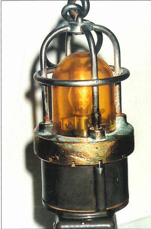
Abb. 1: Leuchtenkopf mit Schutzkorb und runden Traghacken, darunter das Zwischenteil (rechts der Arretierstift) mit eingebauter elektronischer Blink-schaltung an der FRIWO-Zugschluss-blinkeuchte Typ 14201 ZBL.
