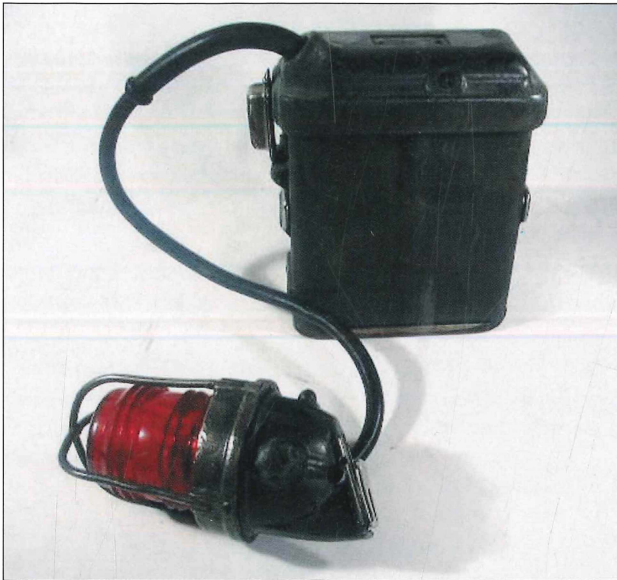
Abb. 2: CEAG Zugschluss-Kopfleuchte vom Typ MLC 4.1 Z mit Leuchtenkopf Typ 1283 Pz mit rotem Kuppelglas. Höhe: 160 mm; Breite: 121 mm; Tiefe: 56 mm; Tiefe des Leuchtenkopfes: 150 mm; Größter Durchmesser des Leuchtenkopfes: 74 mm; Gewicht des Leuchtenkopfes: 0,35 kg; Gesamtgewicht: 2,35 kg
