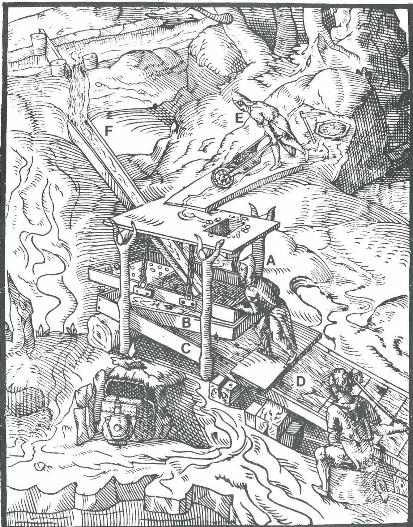
A: Der Goldwäscher, der mit dem »Räder« arbeitet; B: Die mittlere Bühne, auf die das Daurchgesiebte fällt; C: Die untere Bühne, die auf den Planherd führt; D: Der Planherd; E: Der Arbeiter, der auf der oberen Bühne geht und das Geförderte durch ein Loch
