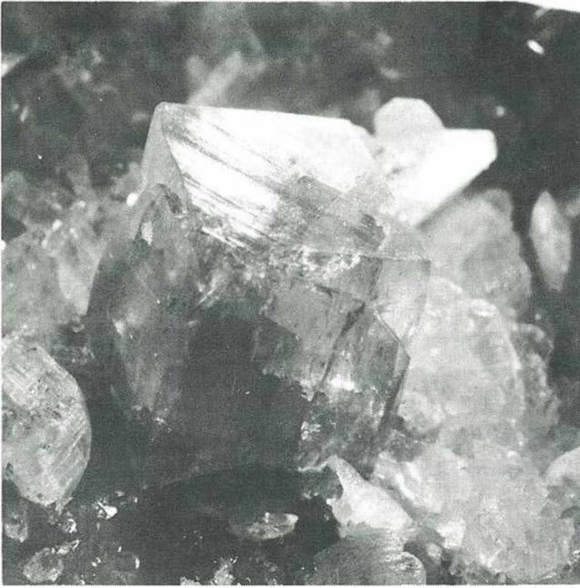
Coelestinkristall, Größe etwa 1 cm. Oben, zur Hälfte spiegelnd und gestreift die vordere Endfläche (100). In der Mitte des Kristalls (dunkel) die kleine dreieckige Fläche (210). Das Prisma wird nur durch (011)-Flächen gebildet. Die (111)-Flächen sind nur ganz schmal, kantenabstumpfend vorhanden. Katschberg-Autobahntunnel Nord, Station 840 m, Paragenese 5.
