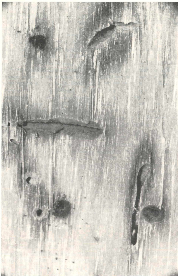
Abb. 7: Larvengänge des Hylurgonotus brunneus SCHEDL, 1951 mit verpilztem Kot. Verfärbung des Holzes im Bereich der Gänge durch Pilze.
