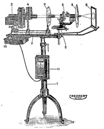
eingehend beschriebenen einfachen Zusammenstellung (Bogenlampe, Kühlküvette, Mikroskop mit Umkehrspiegel), die sich auch besonders für die Anfertigung von Zeichnungen nach Projektionsbildern eignet, sei hier eingehender der Mikro-Projektionsapparat der Reichertwerke an Hand der vorstehenden Abbildung 2 besprochen. Der Apparat besteht aus einem fahrbaren Untergestell (1), welches eine weitgehende Höhenverstellung der Projektionseinrichtung gestattet, aus einer kurzen optischen Bank (2)
