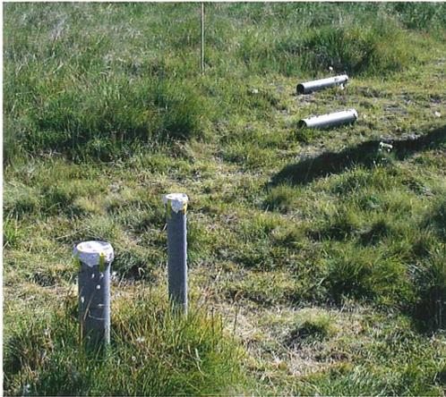
bb. 1: Nardus Wiese, Mofettenstandort bei Milhostov, im Vordergrund die Zylinder zur Messung des CO<sub>2</sub>-Flusses.
