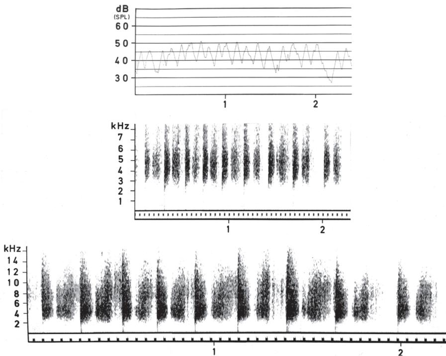
**Abb. 3:** Struktur der Laute von *C. caraboides*. Absolute Schalldruckpegelkurve, Entfernung Käfer-Messmikrophon 1 cm (oben) mit Sonagramm, Frequenz 80-8 000 Hz (Mitte) und Sonagramm, 160-16 000 Hz (unten); die Zeitmarken am unteren Sonagrammrand entsprechen 0,05 s.
