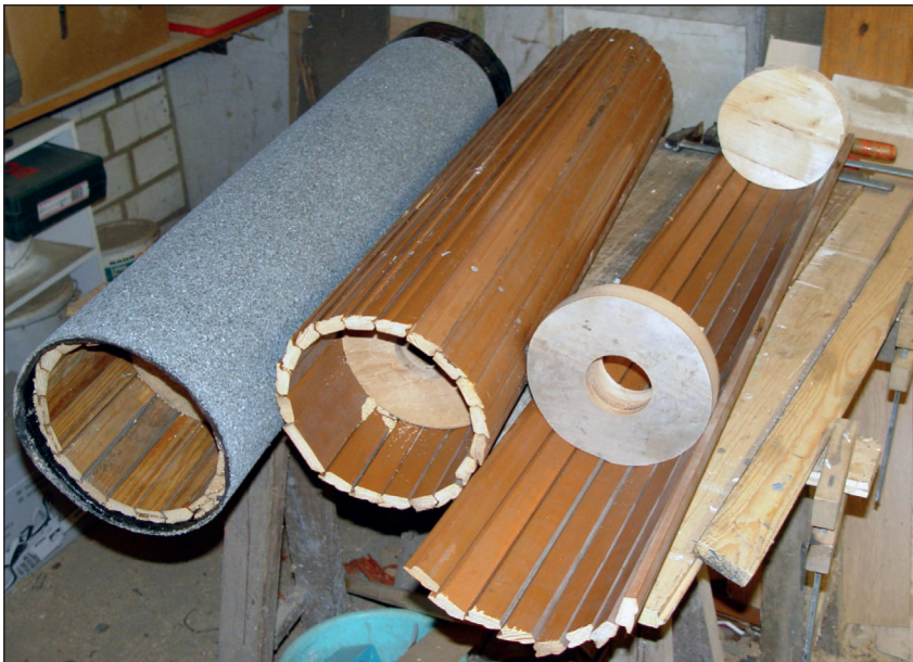
Abbildung 9: Bauphasen einer einfachen Steinkauzbrutröhre, 2011
