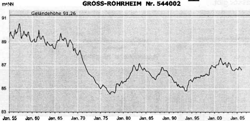
Abb. 4: Ganglinie des Grundwasserstands an der Messstelle 544002 Groß-Röhrheim, die im Absenkrichter eines Großwasserwerks liegt.
