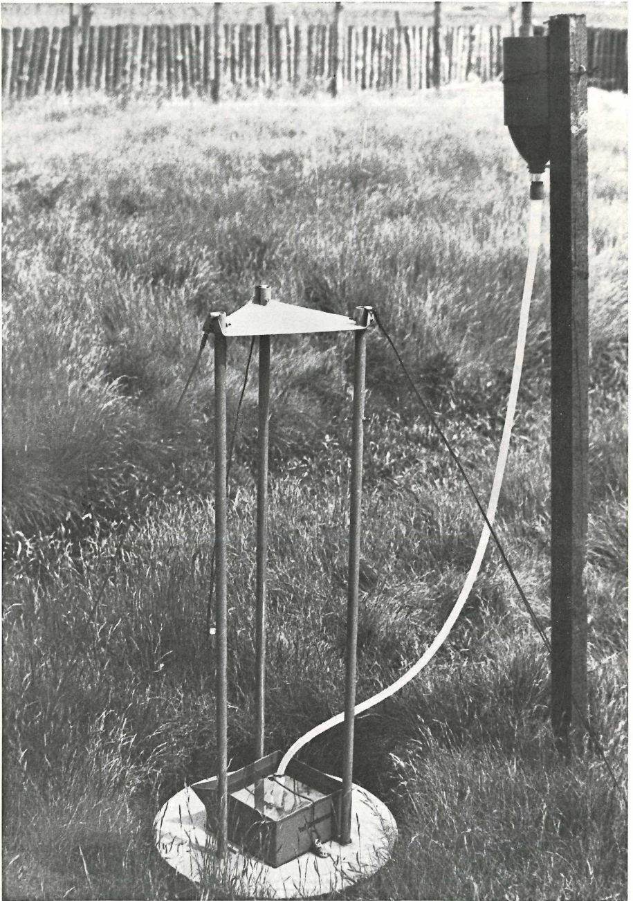
Abb. 3: Hebesystem mit Blauschale im Freilandeinsatz. Ort: Meldorfer Bucht – Unteres Festucetum, 50–55 cm über MThw (s. Weigmann 1970) – Zur Zeit der Aufnahme nicht überflutet. Das Gleitsystem ist mit Spanndrähten zusätzlich gesichert worden. Für den Wasser- nachlauf sorgen ein flexibler Kunststoffschlauch und eine 2-l-Kautexflasche.
