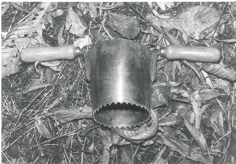
Abb. 1: Probennehmer für die Bodenproben zur Sieb-Flotations-Methode
