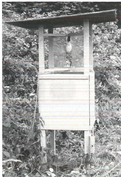
Abb. 13: Die verwendete Kastenfalle mit Quecksilberdampflampe und Blick in den Fangkasten mit den lebenden Faltern
