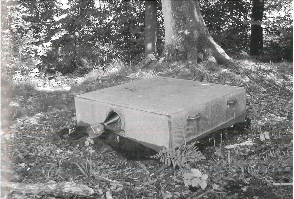
Abb. 3 Photoelektor mit Sammelgefäß (Foto: Arp)
