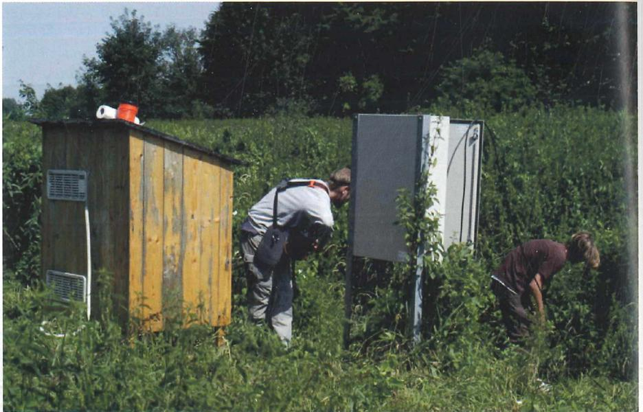
Foto 12: Kontrolle der Messgeräte am Duvenseebach. Hier werden im Stundentakt die Nährstoffgehalte von Wasserproben registriert (Foto: Mona Dahmen).
