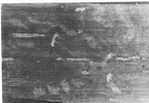
Abb. 3: Fraßspuren in Eichenholz; die helle Feinsandfüllung der Bohrgänge ist deutlich zu erkennen; x 1,2
