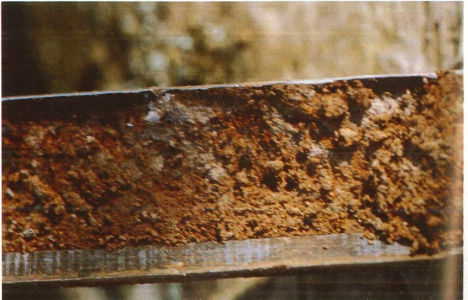
Abb. 22: Das Bohrgut von Standort 3, Bodentyp: Pseudogley (Foto: H. HASS).
