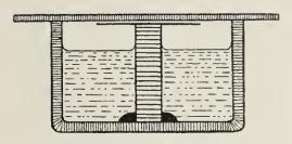
Fig. 1. Glasschälchen im Längsschnitt. <sup>3</sup>/<sub>4</sub> nat. Gr. Das Deckglas ruht auf einem Glasstab. der mit Siegellack auf den Boden des Schälchens geklebt ist.
