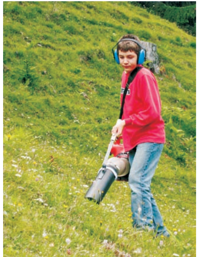
Abb.3: Motorgetriebener Saugapparat (VAC) zum Fang der Zikaden aus dem Grünland
