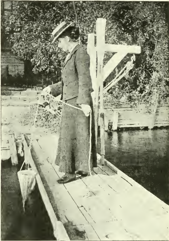
Fig. 5. Das kleine Planktonnetz für Teiche in seiner Handhabung.
