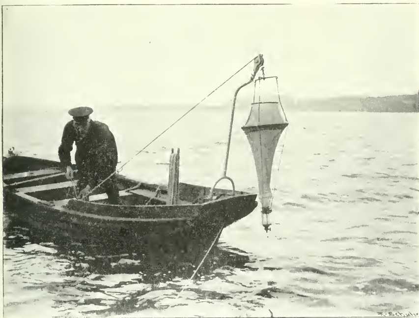
Fig. 7. Grosses Planktonnetz gebrauchsfertig zur Ausführung eines Vertikalfanges. Nach einer Photographie von Dr. O. Z. mit Goerz-Anschütz' Klappecamera.
