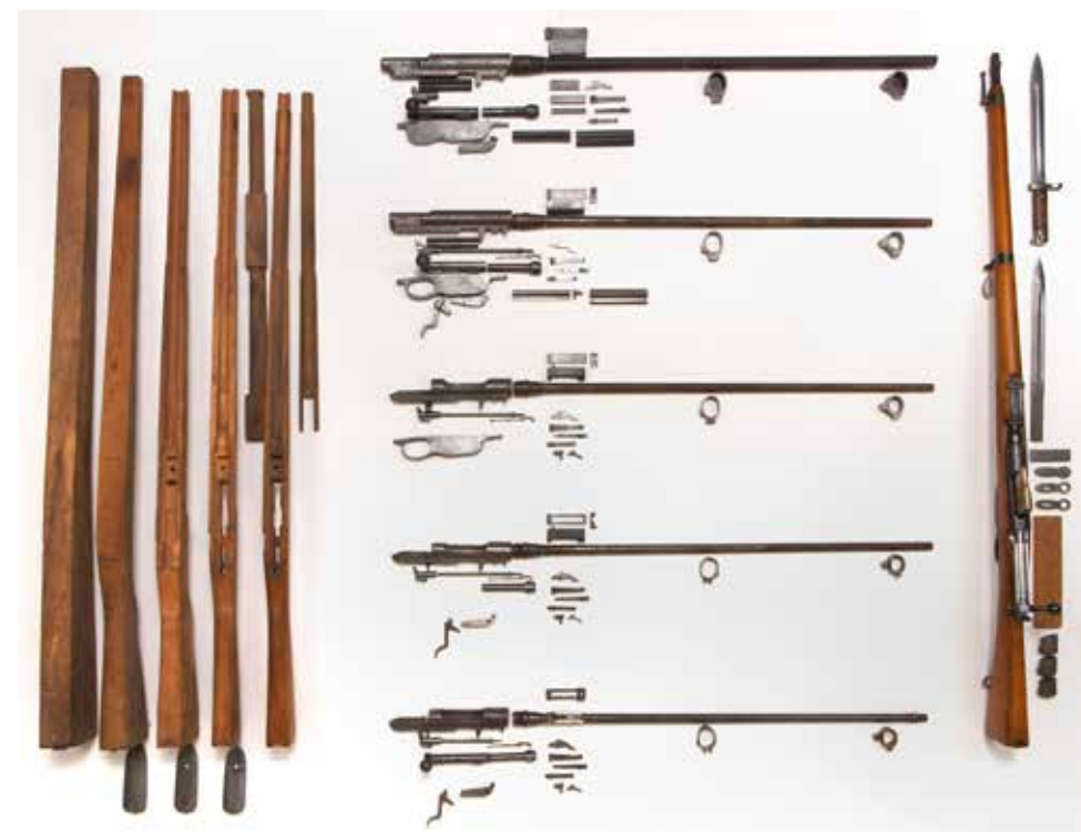
ABB. 81: Erzeugungsstadien Gewehr Mannlicher M 1895, Steyr, Anfang 20. Jh. Eisen und Holz, Inv. Nr. C 2611 (ehem. T 1938 / 0119)
