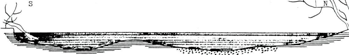
an der zweiten Gabelung, stromabwärts linker Arm, am Südufer sind es bis zur eigentlichen Gabelung noch ca. 2m, starke Schlammablagerungen wegen geringer Strömung, bei Hochwasser dehnt sich hier der Bach am Nordufer um bis zu 7m aus (Zufluß Tümpel!)
