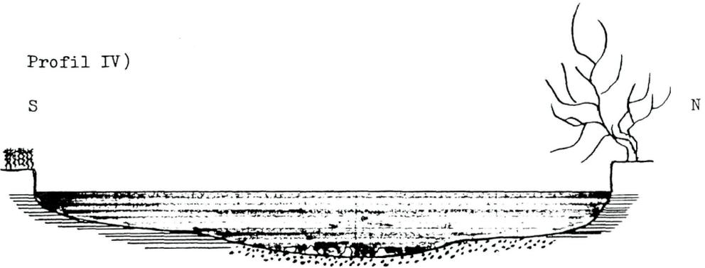
Unterlauf, kurz vor Überlauf zur Traun und Absperrung, der Bach ist hier am schmalsten und relativ tief, Strömung zur Mitte verlagert, dementsprechend an den Ufern starke Schlammablagerungen (vor allem am Südufer - Krümmung!)
