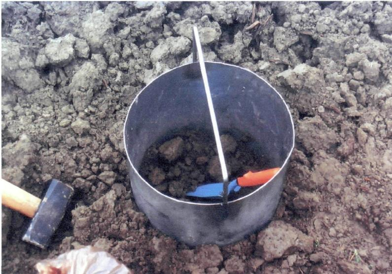
Abb.2: Geräte zur Probenentnahme
