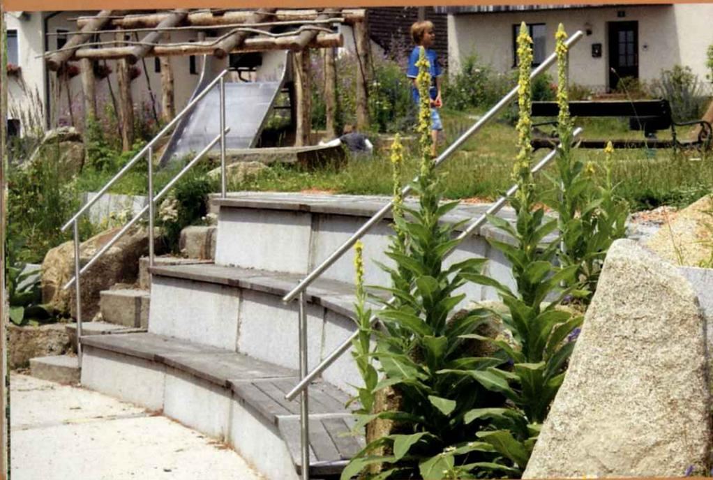
Als **Stein** wurde Granit gewählt – aus Kostengründen in Kombination mit Beton. In geschnittener und sandgestrahlter Form für Säulen und Stützmauern, in behauener Form für Pflaster und Stufen, als Findlinge für Stützmauern, Hüpfsteine und Sitzblöcke.
