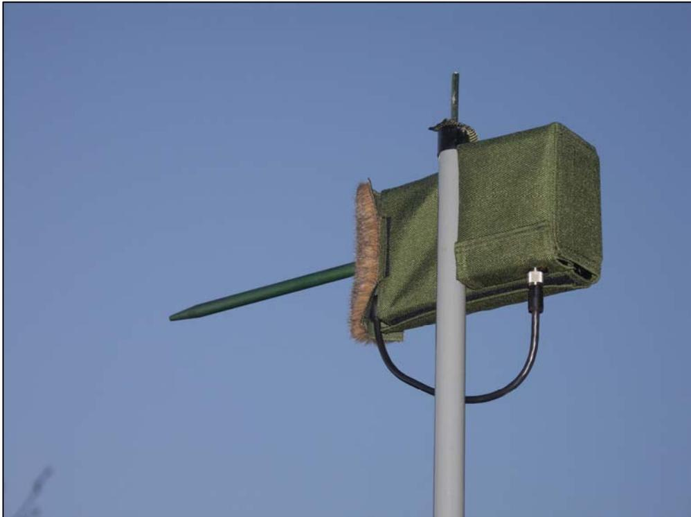
**Abb. 11** Automatische Registriereinheit („batcorder“, ecoObs, Nürnberg)
