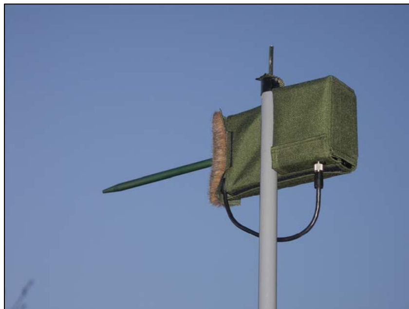
Abb. 3 Automatische Registriereinheit („batcorder“, ecoObs, Nürnberg).
