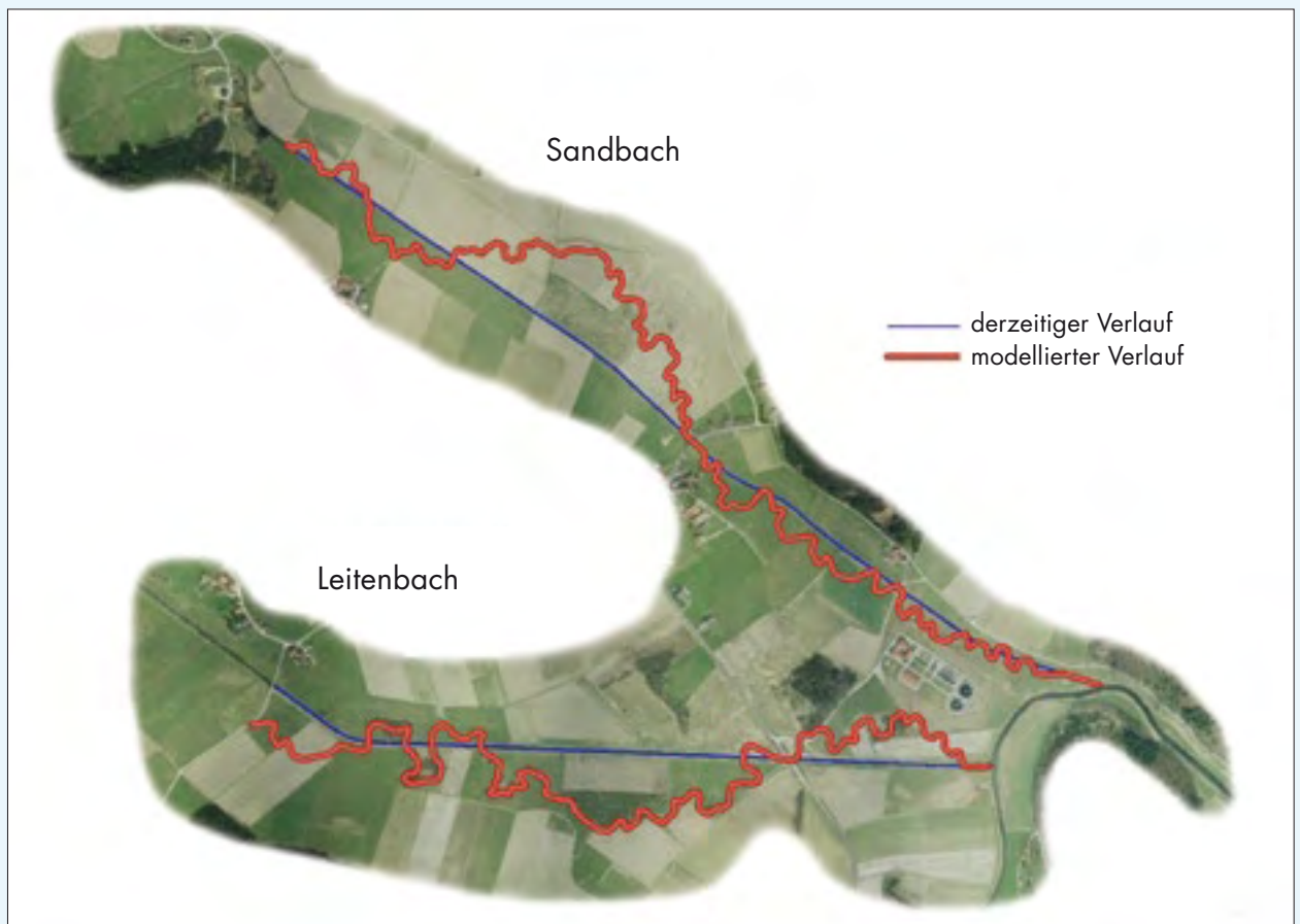
Abb. 48: Gegenüberstellung des derzeitigen Verlaufes von Sandbach und Leitenbach mit dem möglichen Verlauf nach der Renaturierung.
