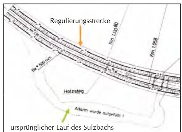
Abb. 109: Ausschnitt aus dem Regulierungsoperat des Sulzbaches (Bauabschnitt 1)
