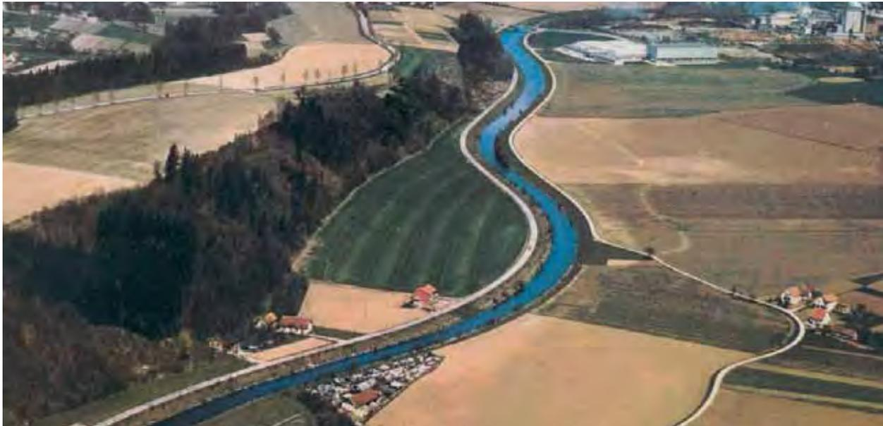
Abb. 2: Regulierung der Kreams bei Weißenberg-Nettingsdorf (Quelle: PAPLHAM et al. 1976)
