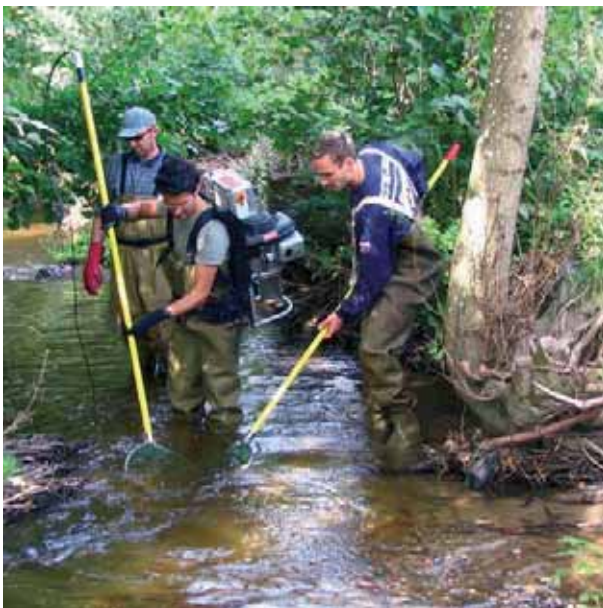
Abb. 3: Fischbestandsaufnahme mittels Elektrofischung in einem naturnahen Abschnitt
