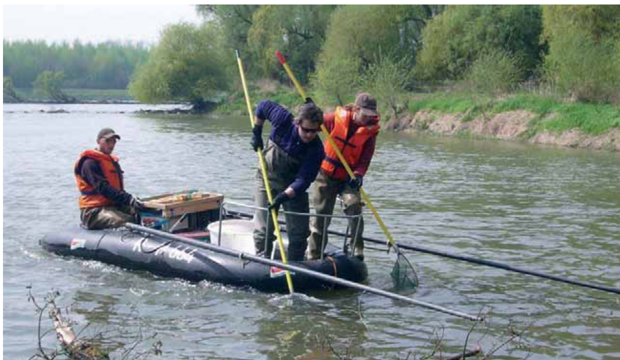
Abb. 47: Streifenbefischung mit einem Elektrofangboot
