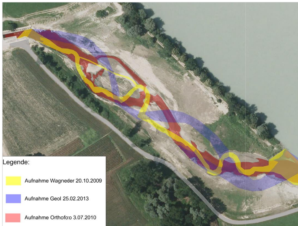
Abb. 48 Umlagerungen des Gurtenbach-Unterlaufs zwischen 2009 und 2013 (Quelle: Gregor Riegler, Gewässerbezirk Braunau).
