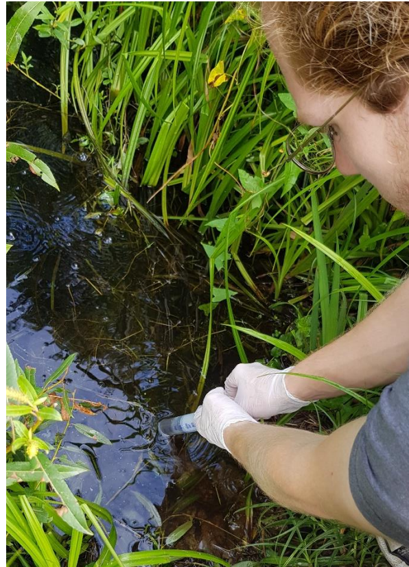
Abb. 3: eDNA-Probennahme: Wasser wird mittels Spritze durch einen Filter gepresst. © H. Sattmann
