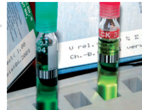
linke Küvette: Überschreitung des Messbereichs, Anzeige: 1,78 mg NH_4 -N/l rechte Küvette: Messbereich in Ordnung, Anzeige: 24,3 mg NH_4 -N/l
