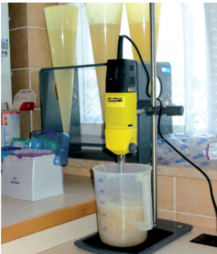
Zum Homogenisieren bzw. Zerkleinern der Feststoffteile der Probe wird ein Dispergiergerät verwendet.
