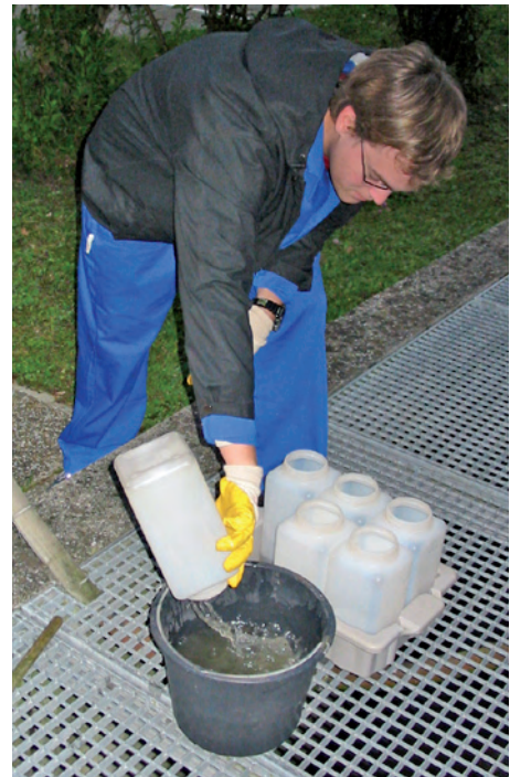
Teilproben aus mehreren Probengefäßen werden in einem Eimer zur Tagesmischprobe vermengt.
