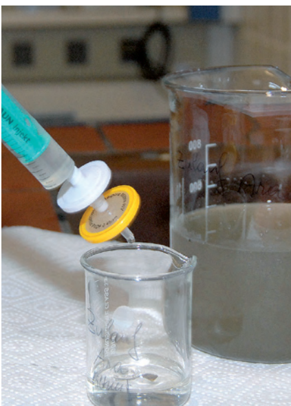
Die Probe wird vor der Nährstoffanalyse filtriert.
