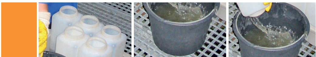
Teilproben aus mehreren Probengefäßen werden in einem Eimer zur Tagesmischprobe vermengt.
