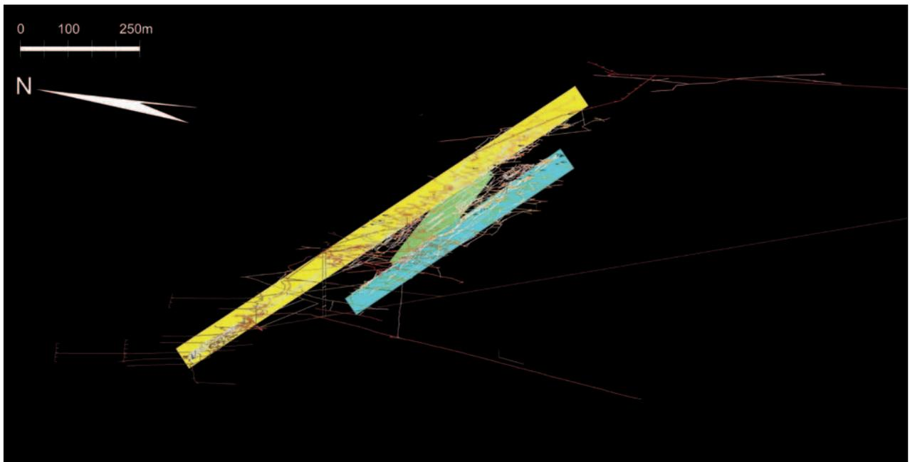
Abb. 12: 3D Südansicht des Schneeberger Grubenkörpers. In hellblau ausgehalten die vermutete Lage des Liegendganges, in gelb die des Hangendganges und in grün die Lage des Querganges.
