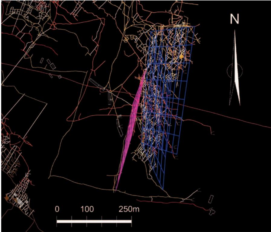
Abb. 25: Westansicht des Grubengebäudes und des Querganges mit Lage der Falte in der Lagerstätte. Deutlich zu erkennen ist hier, dass der Quergang nur an einem bestimmten Bereich an die Falte anschart, und zwar auf der Höhe des Rudolfstollens (ca. 2330 m).
