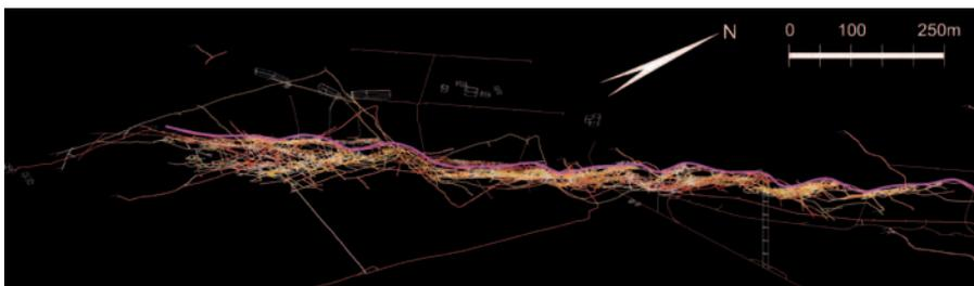
Abb. 27: 3D Südostansicht des Grubenkörpers. Gut ersichtlich ist die wellige Form des Erzkörpers an der Erzkörperoberkante (violette Linie).
